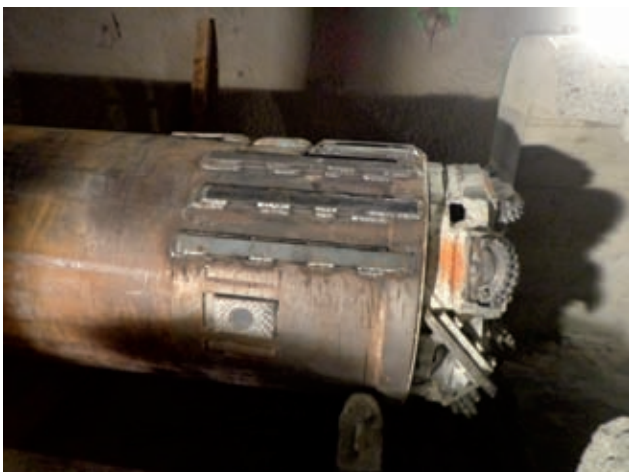
Bohrkopf der 800 mm-Großlochbohrung Bild: PORR
