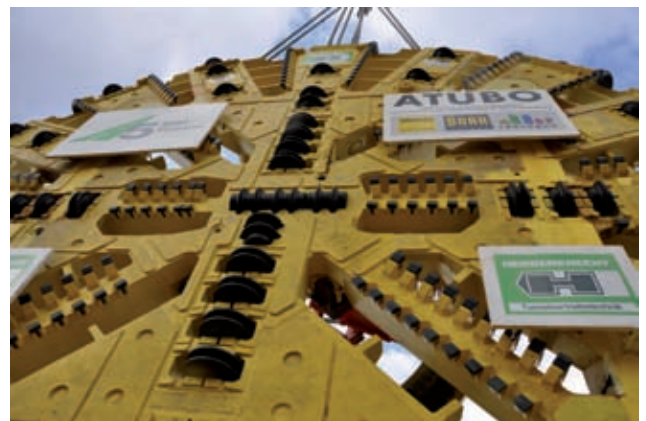
Schneidrad TVM Bild: PORR
