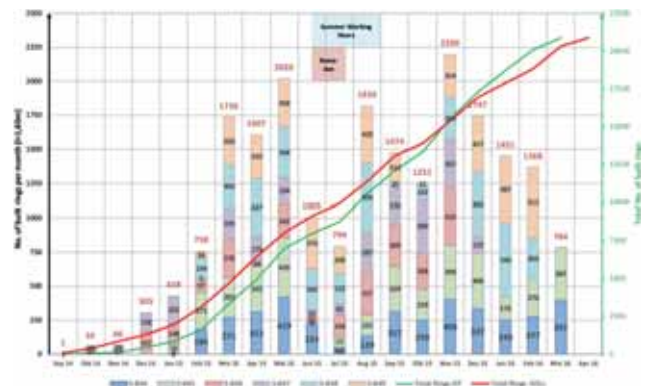
Gesamtvortriebsleistung der TVM's Bild: PORR AG
