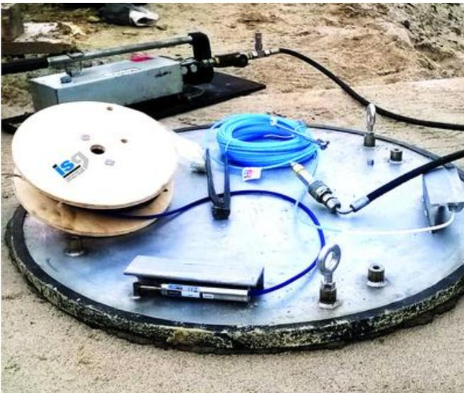
Druckmesskissen für den Fuß vor der Montage an den Bewehrungskorb. Bild: isg
