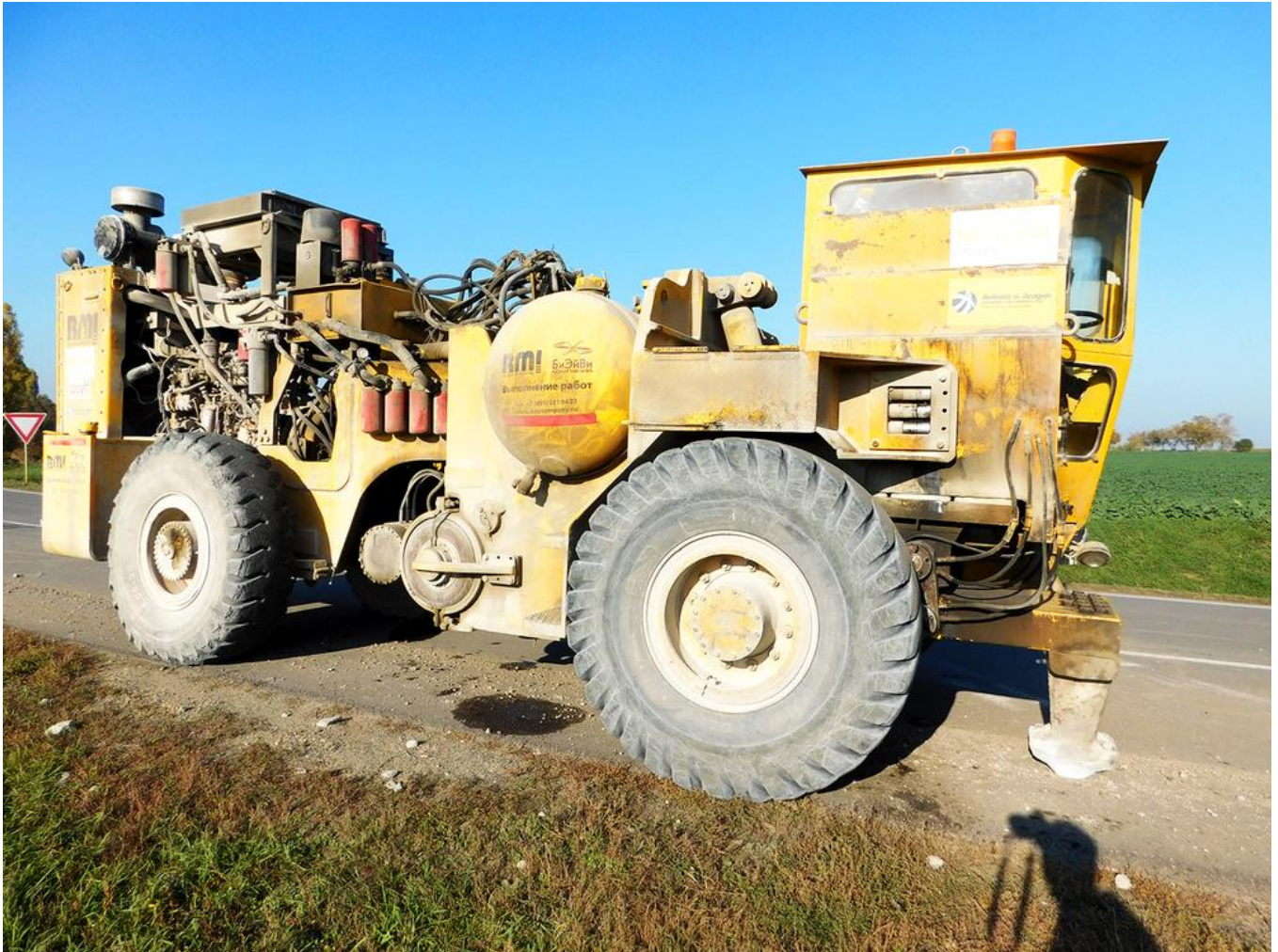
RB 500 Resonanzbrecher – Baumaschine zum Abreißen des Betonunterbaus. Bild: PORR AG
