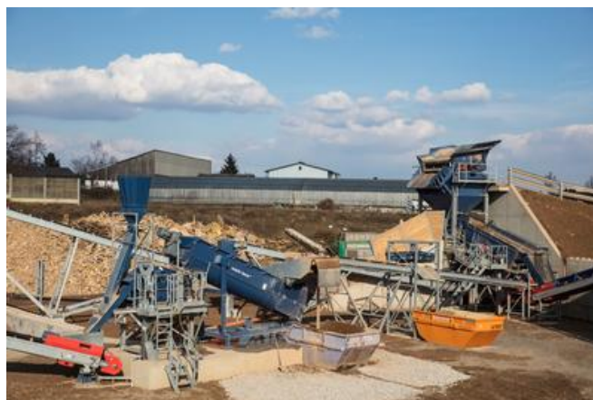
Der Leichtstoffabscheider mit Entwässerungssieb in der 1. Ausbaustufe. Quelle: Daniel Ulbricht-Sundt
