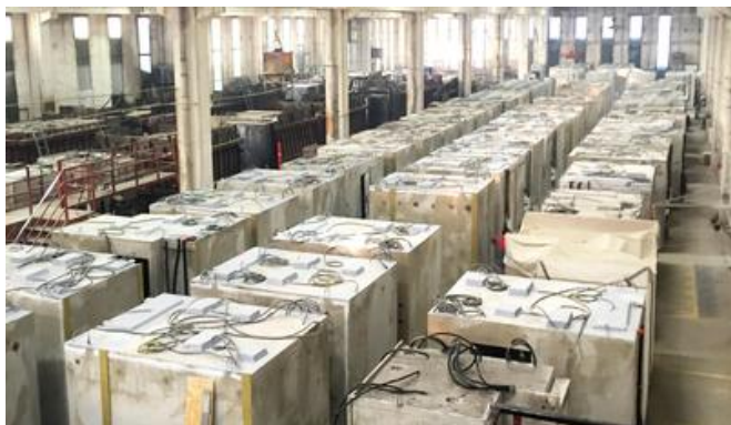
Produktion der Fertigbadzellen aus Stahlbeton. Bild: PORR AG
